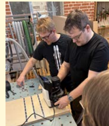
Digital gesteuerte tragbare Fräse (Shaper Tool) im Einsatz
