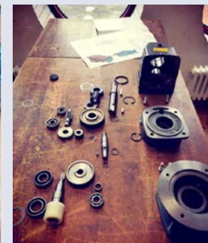
Überblick über Einzelelemente des Stirnradgetriebes
