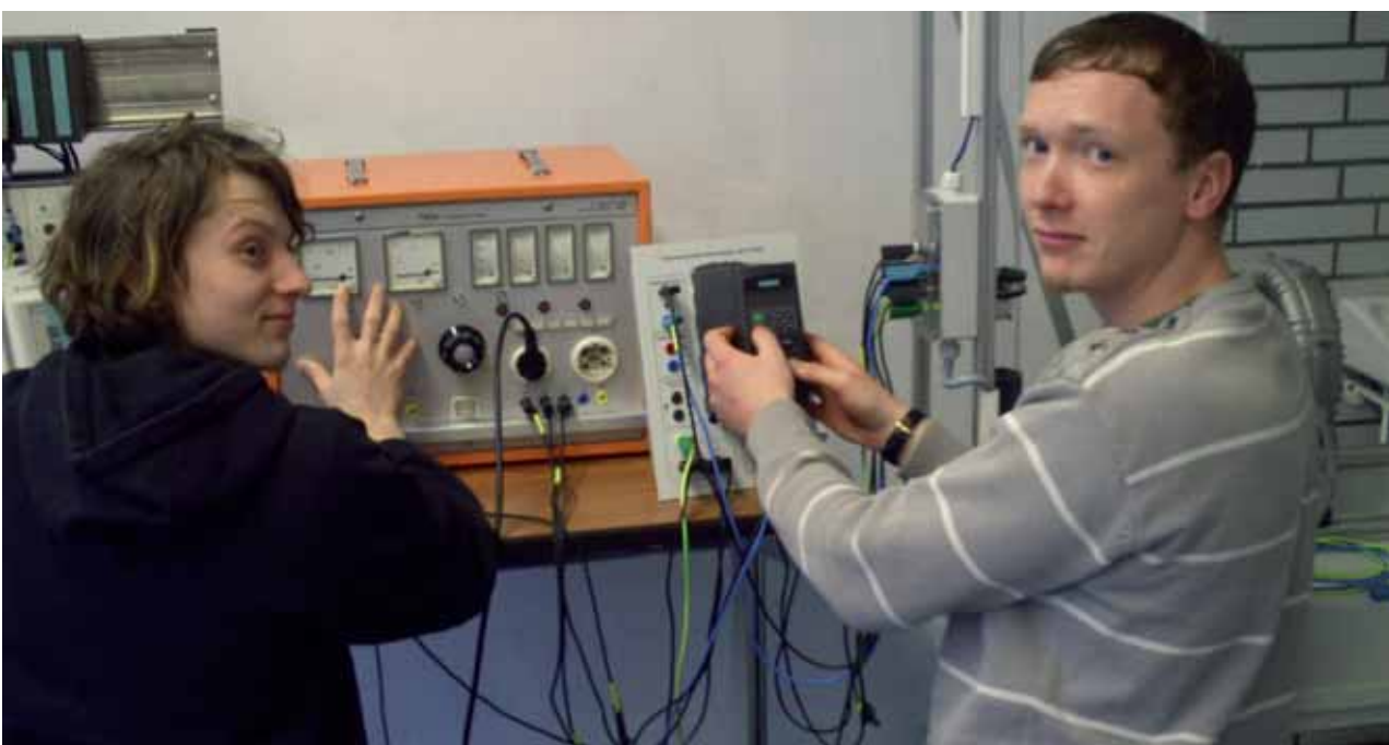
Schüler beim parametrieren eines Frequenzumrichters
