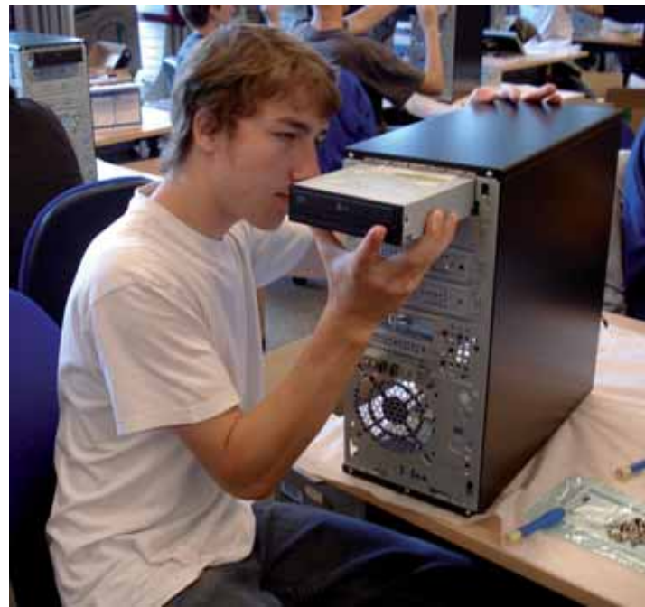
Einbau DVD Laufwerk
