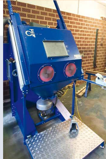
Druckstahlanlage des Herstellers OTI
