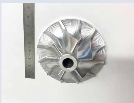
Fertigung eines Flügelrades in Modellgröße
