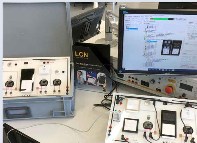
Die Anlage wird mittels einer USB-Schnittstelle über den PC programmiert.
