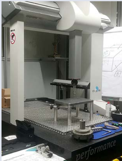
Prüfen der Ebenheit unseres Messtisches auf einer Koordinaten-Messmaschine beim Unternehmen Dräger
