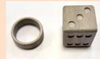
Die ersten gedruckten Metallteile aus dem 3D-Drucker
