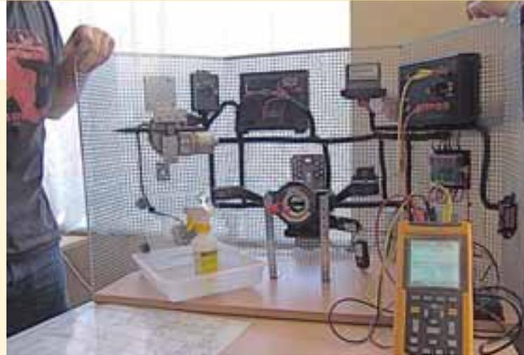
Das Produkt des Projektes in Polen: der Experimentierstand LIN-CAN-Bus
